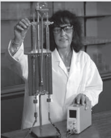
▲ figuur 21 Met het toestel van Hofmann kun je water ontleden.
